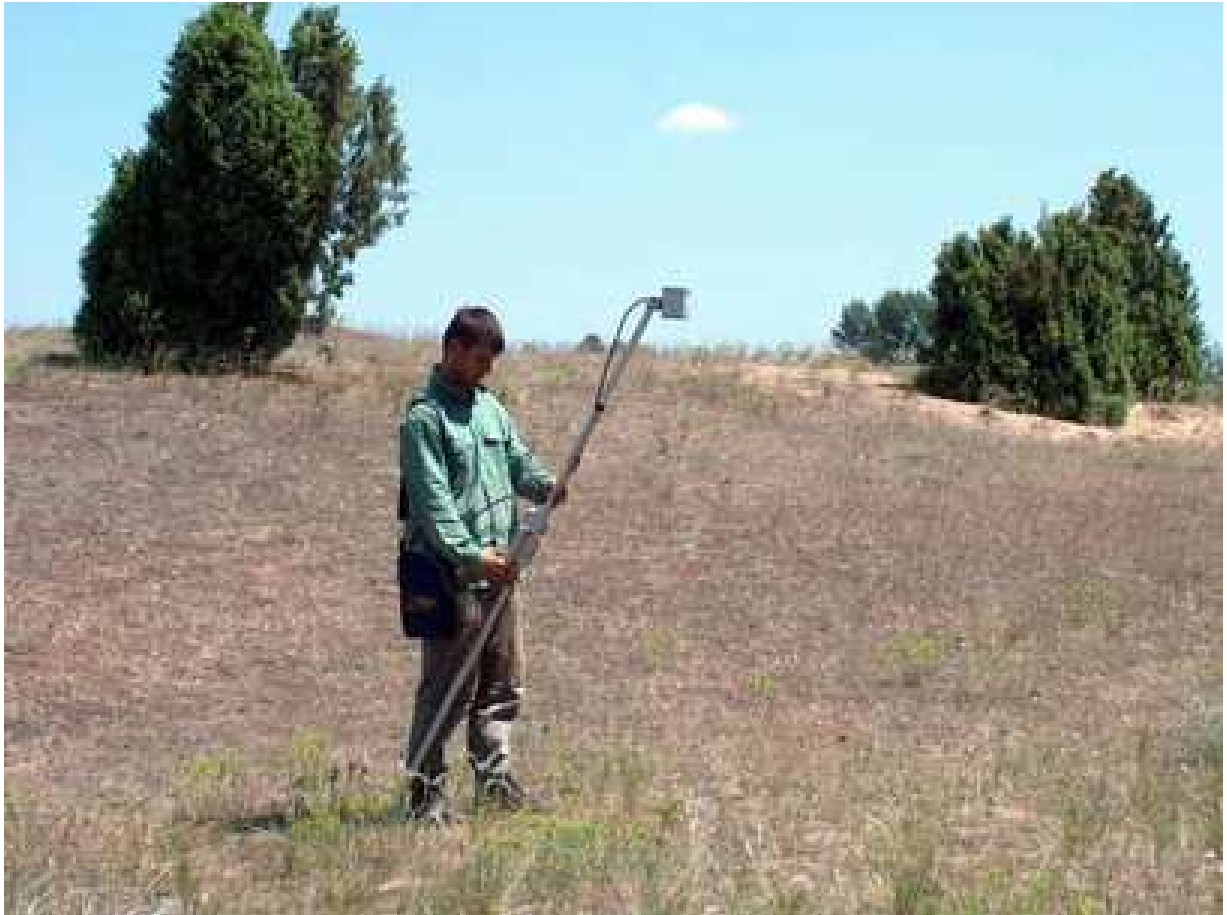
10. ábra Terepi távérzékelés a Cropscan spektrométerrel (Dr Altbácker Vilmos felvétele)
